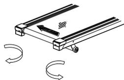
Vyrovnání vychýlení pásu doprava ( diagram 3) Vyrovnání vychýlení pásu doleva( diagram 4)
